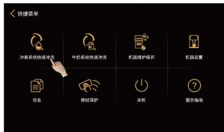
步骤3：根据屏幕提示操作，进行冲煮系统快速冲洗。
