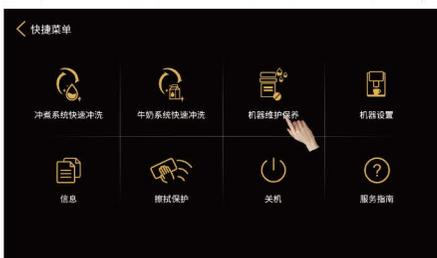
步骤2: 点击屏幕中的“机器维护保养”；
