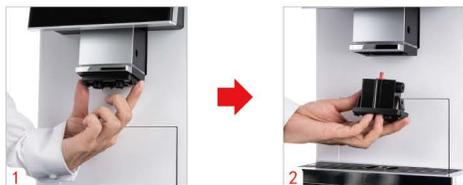
步骤3: 将咖啡出口, 奶沫器, 接头等部件全部拆解开, 拿至水龙头下清洗;
