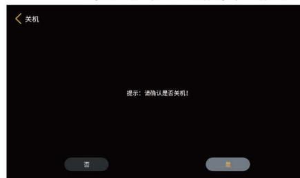
步骤4：在软关机的状态下，按下咖啡机背面电源开关彻底切断咖啡机电源。
