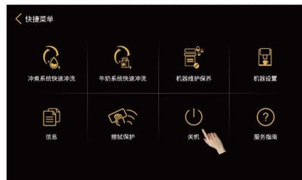
步骤3：根据咖啡机界面提示进行操作，关机完成后进入软关机状态。
