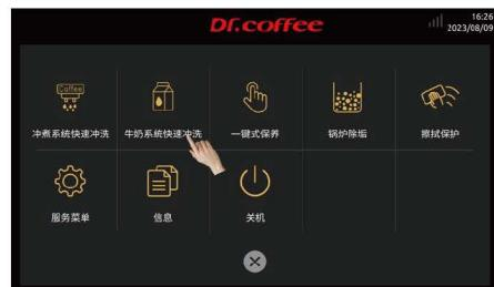
步骤3：根据屏幕提示逐步操作，进行牛奶系统快速冲洗。
