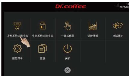
步骤3：根据屏幕提示逐步操作，进行冲煮系统快速冲洗。
